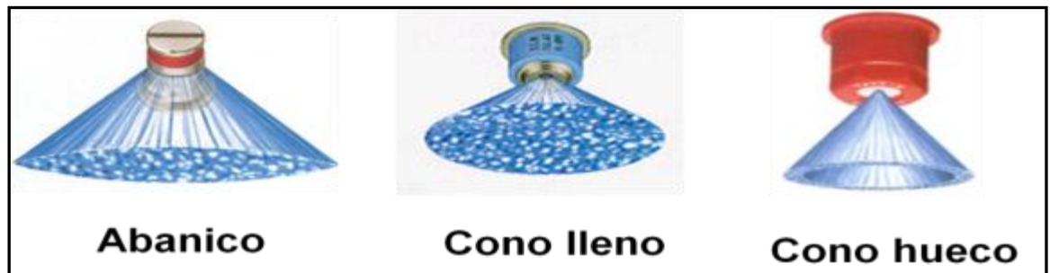
Figura N° 30 Boquillas de abanico, cono lleno y hueco
