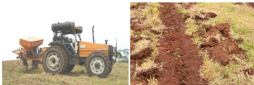
Equipo Integrado Preparación Suelos Subsolador- Abonadora - Pulverizadora Herbicidas
